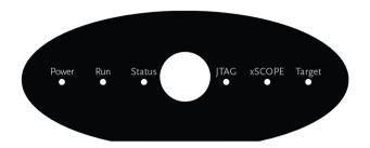
Figure 3: xTAG-PRO LEDs
